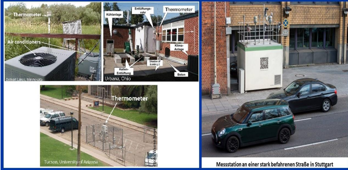
Abbildung 9: Temperatur-Messfühler in der Nähe von Wärmequellen in Stuttgart, Detroit Lakes/Minnesota, Urbana/Ohio und Tucson/Arizona. Dies ergibt unrealistische Messwerte
